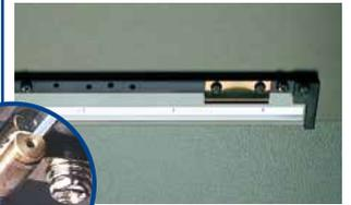
Commande des axes X, Y et Z et réglage fin central des axes X et Y. Réglage fin axe Z déporté.
